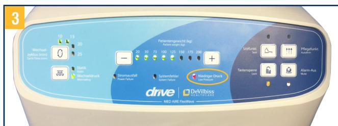
Régler le poids du patient au moyen des touches (+) et (-) sur l'échelle de réglage du poids\*. Lorsque la LED « Pression basse » s'éteint et que la LED « Pression normale » s'allume, vous pouvez placer le patient sur le matelas.
