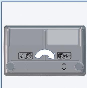
Schalterleiste drehen und einsetzen. Pfeile beachten!
