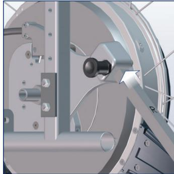
Kippstütze in Halterung schieben und Rastbolzen einrasten lassen.
