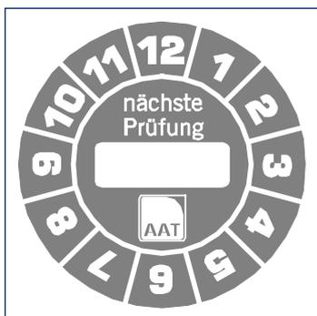
Um eine einwandfreie Funktion des Geräts zu gewährleisten, empfehlen wir alle 2 Jahre eine sicherheitstechnische Prüfung. Wir empfehlen außerdem die sicherheitstechnische Prüfung vor jedem Wiedereinsatz.
