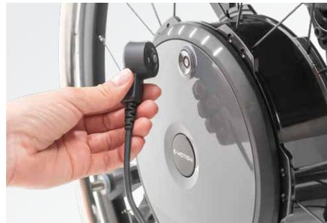
Alles im Griff: Ein-/Aus-Schalter mit magnetischer EasyConnex Ladebuchse. Der Stecker des e-motion Ladegerätes findet automatisch seine Position.
