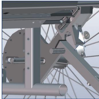
Kippstütze in Halterung schieben und mit Sicherungsstift sichern.
