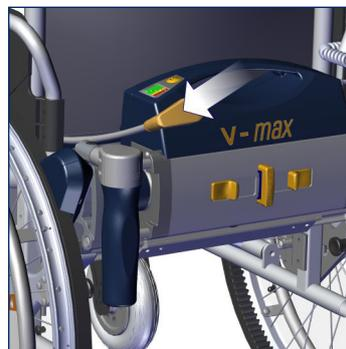
Anderes Ende der Powerleitung in die Buchse der Antriebseinheit einstecken.
