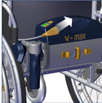
Powerleitung an der Antriebseinheit ausstecken.
