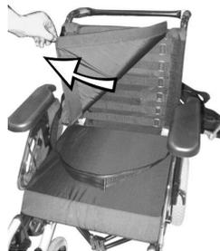
Entfernen Sie das Rückenpolster (mit Klettverschlüssen befestigt), indem Sie es nach oben abziehen, um die Verstellbänder zugänglich zu machen.
