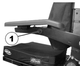
1. Die Schraube zur Verstellung des Armlehnenwinkels (1) mit dem Inbusschlüssel lösen.
