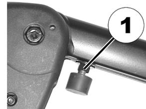
Kontermutter (1) mit dem Gabelschlüssel lösen.
