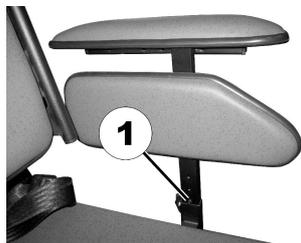
Die Armlehne der fest gepolsterten Sitzereinheit verfügt über eine Schraube (1), die als Anschlag dient. Die Höhe der Armlehne wird über diesen Anschlag eingestellt.
