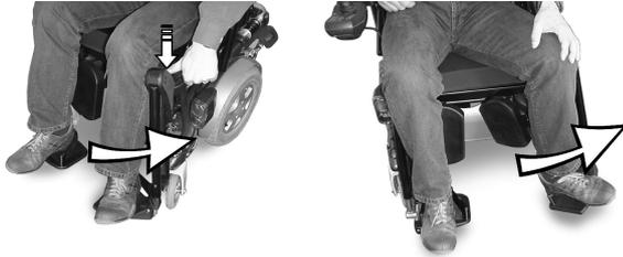
Beinstütze entriegeln und nach außen schwenken.
