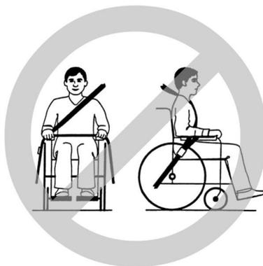
Sicherheitsgurte dürfen nicht durch Teile des Elektrofahrzeugs, wie z. B. Armlehnen oder Räder, vom Körper des Benutzers ferngehalten werden.
