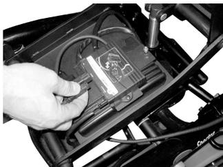
Stecker des Fahrpultkabels aus dem Elektroniksystem herausziehen.
