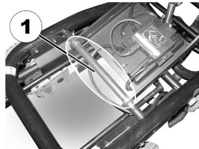
Darauf achten, dass keine Kabel im Bereich der hinteren Haltestange (1) liegen und beschädigt werden können.
