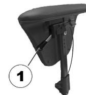
Der Hebel (1) zur Verstellung des Rückenwinkels befindet sich auf der gegenüberliegenden Seite vom Fahrpult unter der
