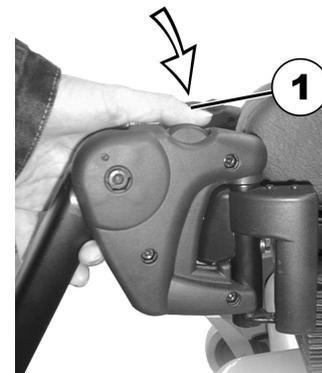
1. Entriegelungsknopf (1) drücken und Fußstütze/Beinstütze nach außen schwenken.
