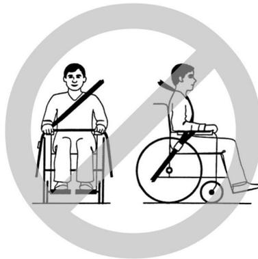
Der Beckengurt sollte zwischen Becken und Oberschenkel des Benutzers verlaufen und darf weder blockiert werden noch zu locker sitzen. Der ideale Winkel des Beckengurts zur Horizontalen liegt zwischen 45° und 75°. Der größte zulässige Winkel beträgt zwischen 30° und 75°. Der Winkel sollte niemals kleiner als 30° sein!
