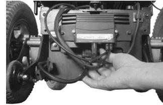
Das Batteriekabel vom Elektronikmodul trennen.
