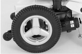
1. Den Drehschalter entgegen dem Uhrzeigersinn drehen.
