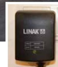
24-Volt-Antriebssystem mit elektronischem Schaltnetzteil (SwitchMode) direkt an der Steckdose im Netzsteckergehäuse integriert
