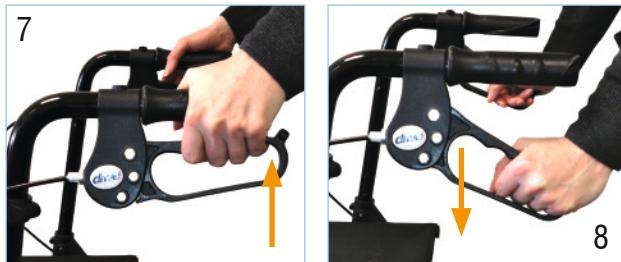
Die Bremswirkung der auf die Hinterräder wirkenden Betriebsbremse ist dosierbar und von der Betätigungsrichtung abhängig. Zum Feststellen / Parken des Rollators beide Bremsgriffe nach unten drücken bis sie einrasten (siehe Abb. 8)
