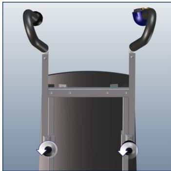
Feststellschrauben der Handgriffe ⑥ entgegen dem Uhrzeigersinn drehen.
