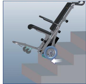
c-max U1 nach vorne schieben, bis Sicherheitsbremsen greifen.
