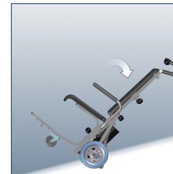
Zum Abbremsen den c-max U1 etwas stärker kippen, damit die Sicherheitsbremsen greifen können.
