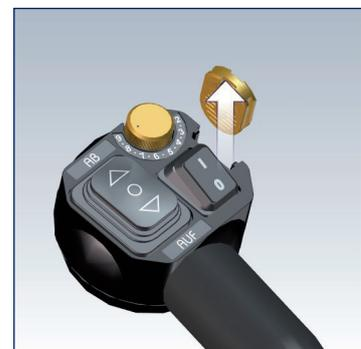
Sicherheitschip für Wegfahrsperre abziehen.
