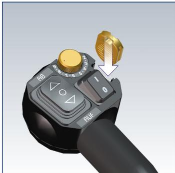
Sicherheitschip ⑰ für Wegfahrsperrung einsetzen.
