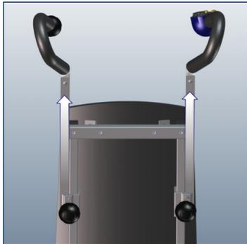
Ggf. Handgriffe auf Schulterhöhe ausziehen und mit Feststellschrauben fixieren.
