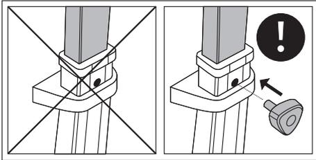
Das scalacombi darf nur dann betrieben werden, wenn das Handrad für die Griffereinheit [16] in das Standrohr [15] und das Handrad [13] in die Antriebseinheit [6] eingeschraubt ist. Die Griffereinheit [18] ist dadurch fest mit dem Antrieb des scalacombi verbunden.
